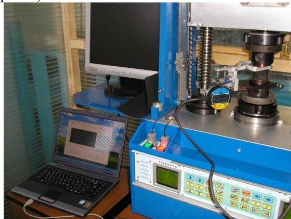
Рис. 1. Лабораторный комплекс ЛКСМ-1К с образцами мерзлого грунта
