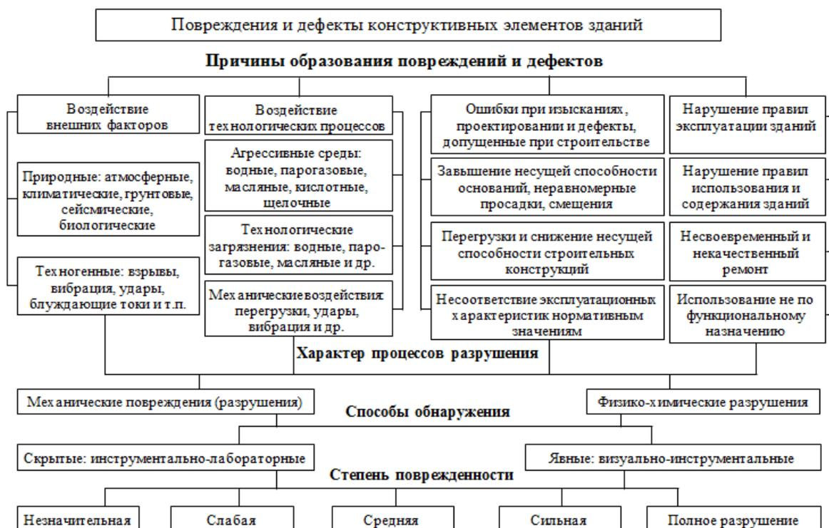
Рис. 2. Классификация повреждений и дефектов зданий
