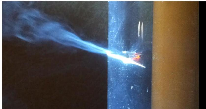
Рис. 3. Задымление установки при полном перекрытии байпасной камеры
