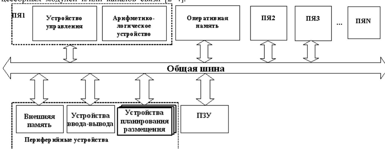
Рис. 1. Структурная схема мультипроцессорной хост-системы
