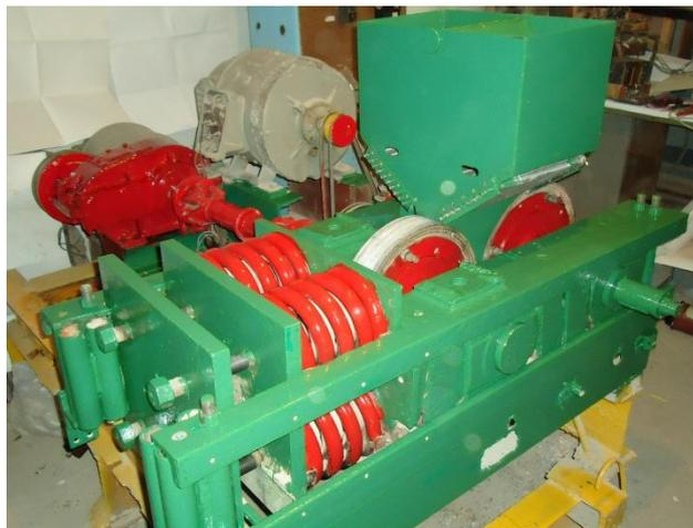
Рис. 1. ПВИ с валковым устройством:
